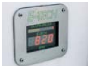
ÜBERBLICK Das Bedienpaneel für Drehzahl und Stromverbrauch. Ein Balken sind 5 Ampere, 820 Touren sind Halblast
