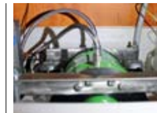
ANTRIEB Der Fünf-Kilowatt-E-Motor von E-Tech ist wassergekühlt. Genug Vortrieb für die 3,1 Tonnen schwere Yacht
